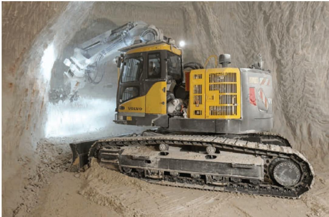
*1- Pelle hydraulique équipée d'une fraise pour l'abattage mécanique (étape de traçage – carrière de Vaujourns)*
