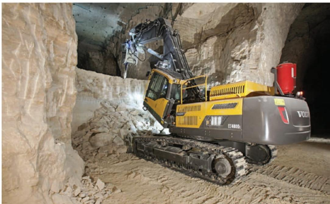
*2- Même pelle hydraulique équipée d'une dent de déroctage vibrante (étape de levage – carrière de Vaujourns)*
